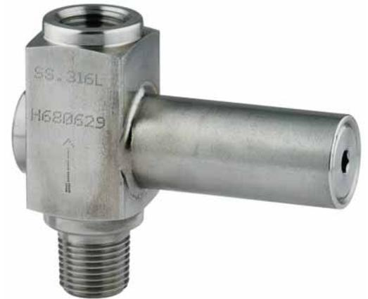
Zum Schutz von Manometern und Druckwächtern an Leitungen, an denen hohe Überdruckwerte auftreten können. Überschreitet der Druck aus unvorhersehbaren Gründen den zulässigen Höchstwert, schaltet die Schutzvorrichtung das Gerät automatisch an der Leitung ab und schaltet es automatisch bei normalisiertem Prozessdruck wieder ein. Der Einsatzdruck lässt sich innerhalb eines umfassenden Bereiches einstellen.
